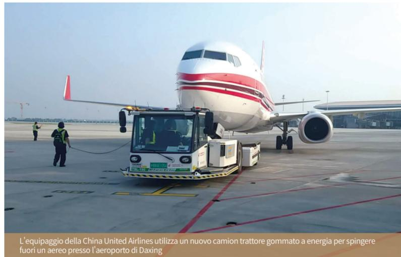
L'equipaggio della China United Airlines utilizza un nuovo camion trattore gommato a energia per spingere fuori un aereo presso l'aeroporto di Daxing
